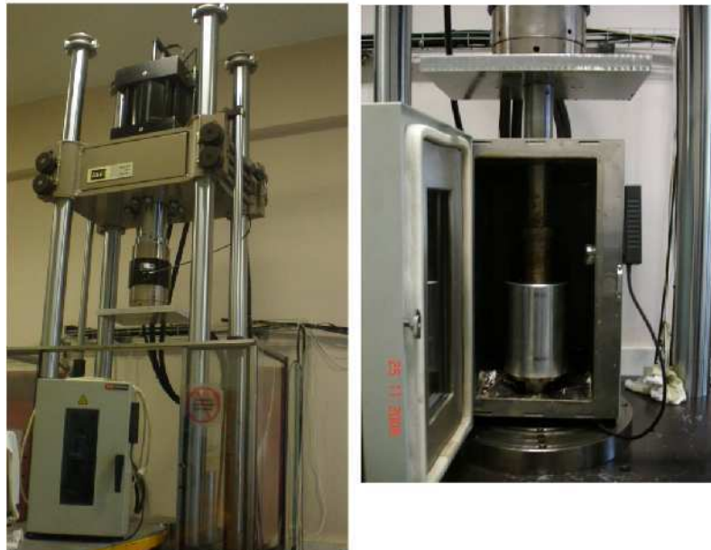
FIG. 1.3 – Presse MTS (1000 kN) et four Instron avec la cellule oedométrique.
