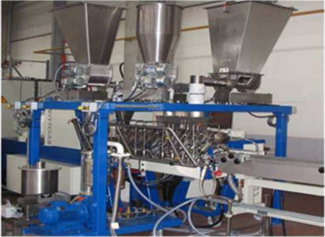
Figure 30 : Extrudeuse bi-vis corotative conçue pour traiter la matière à hautes pressions (jusqu'à 275 bars) en continu et à hautes températures (jusqu'à 400 °C). (PEP, Oyonnax, France)
