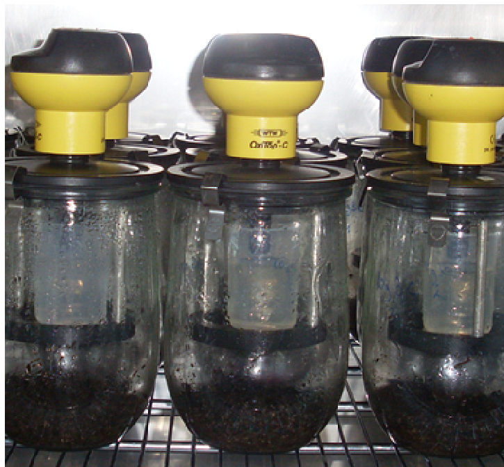
Figure 39 : Les jarres contenant du compost mélangé avec le matériau (LGCIE, EA n° 4126, INSA Lyon-Université Lyon1).
