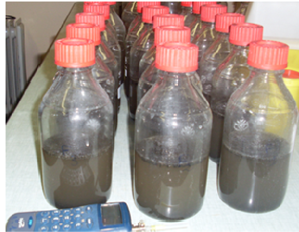
Figure 40 : Dispositif permettant une incubation en anaérobiose (LGCIE, EA n° 4126, INSA Lyon-Université Lyon1).
