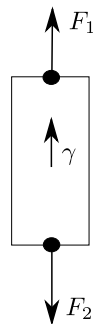
FIGURE 1.20 – Application du principe fondamental de la dynamique à un tronçon de barre
