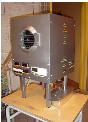
Figure 31 : Schéma de principe et photo du prototype du dispositif de production quasi instantanée d'eau fraîche et de glaçons développé dans le cadre du partenariat industriel
