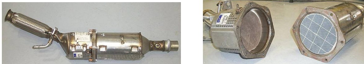
Figure 34 : Vue du filtre à particule installé sur les lignes d'échappement de véhicule diesel
