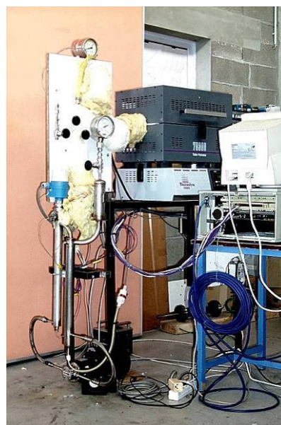
Figure 26 : Caractérisation expérimentale de la réaction \text{MnCl}_2 + \text{H}_2\text{O} \rightleftharpoons \text{MnCl}_2 \cdot \text{H}_2\text{O} et courbe d'équilibre théorique calculée
