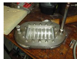
Évaporateur spécialement conçu pour la production rapide de glaçons
