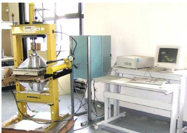
*Fig. II-5. Presse chauffante pour la fabrication des plaques composites.*
