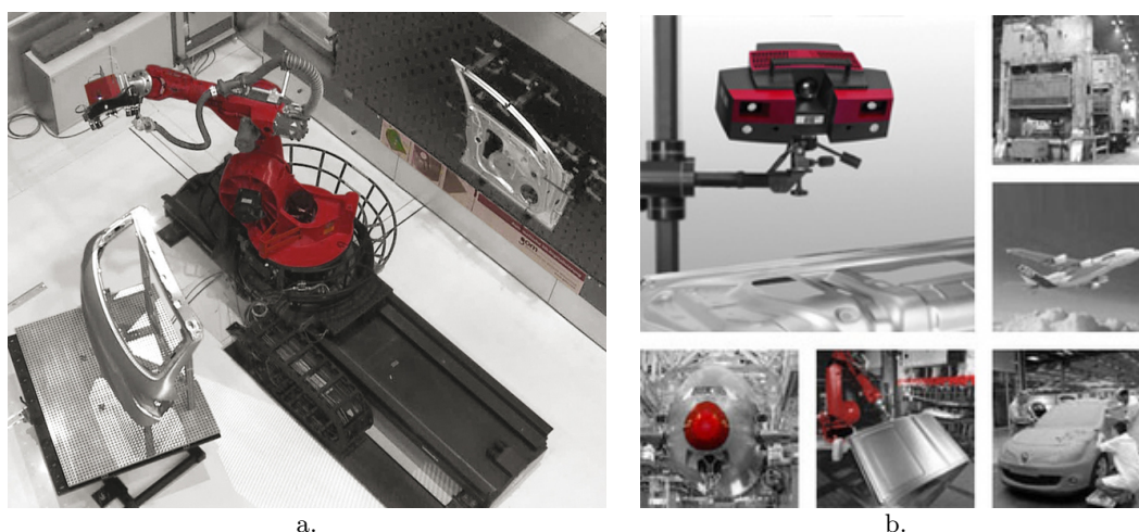
FIGURE 1.22 – Solution automatisée de GOM [27] : a. La cellule d'inspection GOM ATOS b. Scanner ATOS Triple Scan.
