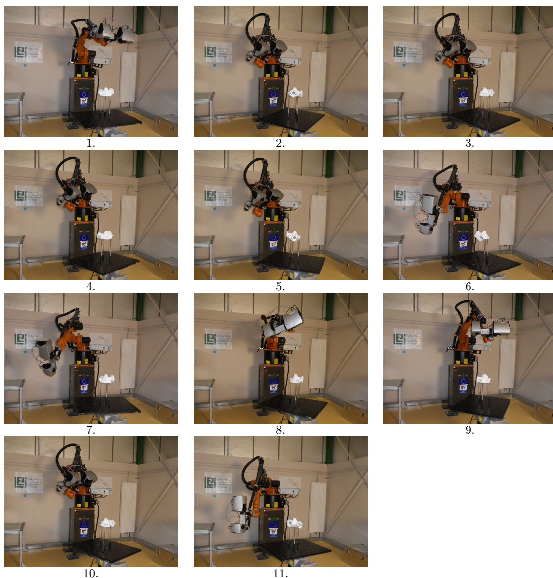
FIGURE 4.28 – Configurations du robot durant l'acquisition par la méthode Barely Visible Surfaces Clustering (BVSC) : 11 acquisitions successives.
