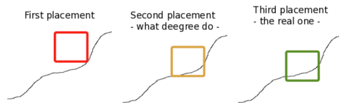
Figure 64. Illustration du problème de positionnement vertical des objets par rapport au terrain
