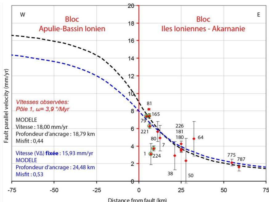
**Figure III.17 : Profil de vitesses GPS perpendiculaire à la faille de Céphalonie (composante parallèle à la faille), en considérant uniquement les sites de Céphalonie et Lefkada Sud, avec les vitesses mesurées issues du pôle 1,  $\omega=3.9^\circ/\text{Myr}$ . La symbolique est identique à celle décrite dans la Figure III.16.**
