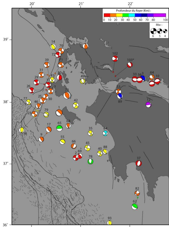
**Figure III.30 : Mécanismes aux foyers de séismes dans la région, modélisés par inversion d'onde.**
