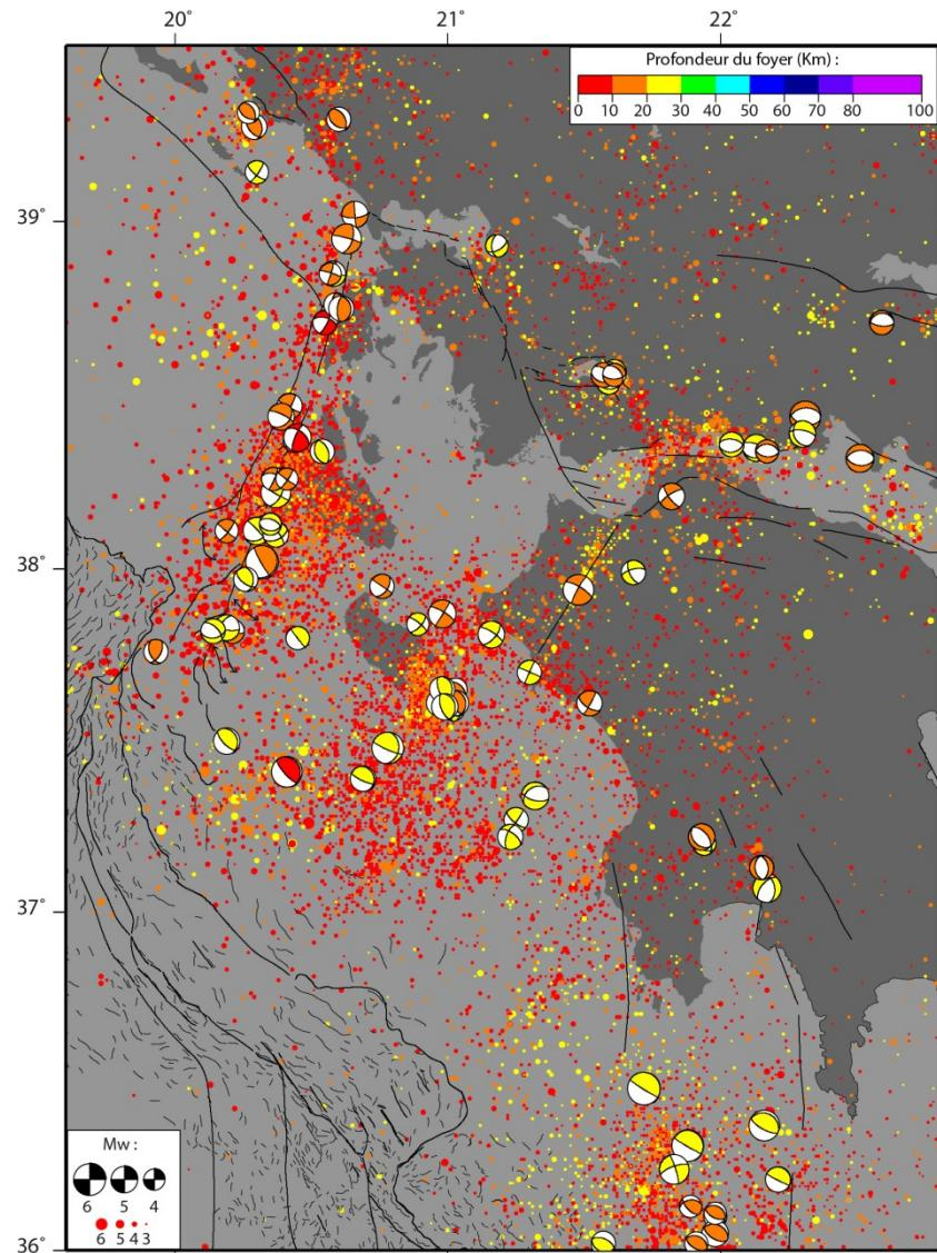
**Figure III.4 : Carte de sismicité de l'Ouest de la Grèce.** Les paramètres à la source des mécanismes au foyer sont issus du Harvard CMT catalog (1976 à 2007) et du Regional CMT catalog (1995 à 2007). Les mécanismes au foyer sont relocalisés suivant le Engdahl et al. [1998] catalog. La distribution de la sismicité est tirée du NOA catalog ( 1970 à 2008).
