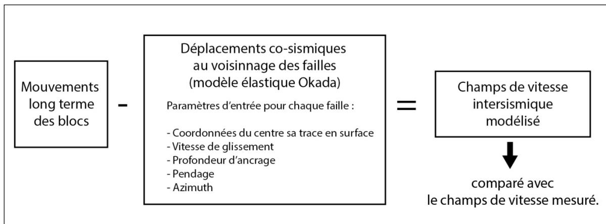
Figure III.23 : Méthodologie utilisée pour le modèle 3D
