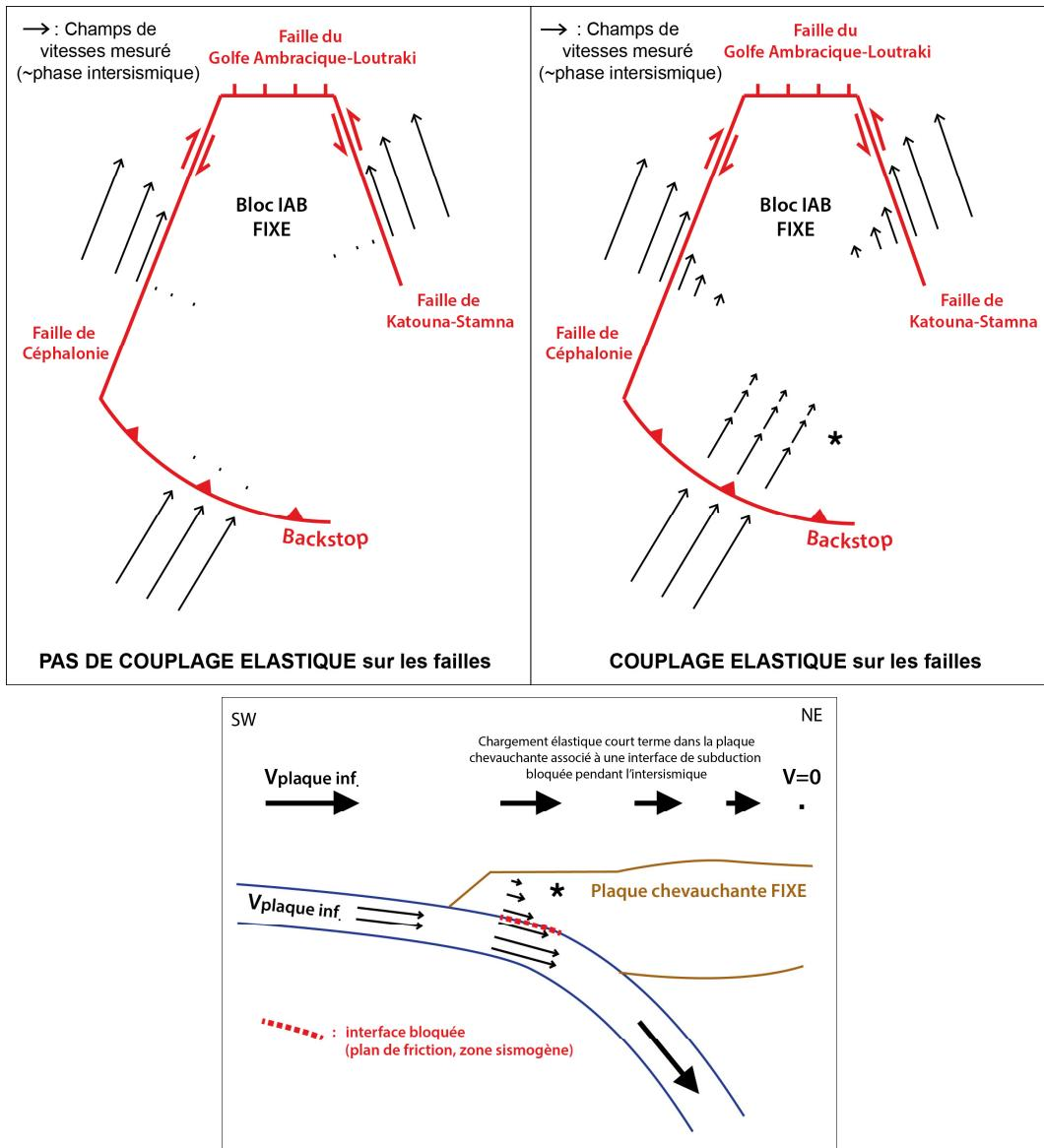
**Figure III. 9 : Les deux vignettes du haut : Mouvement intersismique attendu dans le bloc IAB en cas d'absence ou d'occurrence de couplage élastique associé aux failles bordières du bloc (Céphalonie et KSF) ou du plan de subduction \*. Vignette d'en bas: Schéma expliquant le couplage élastique associé à une zone de subduction. Application au cas du IAB**
