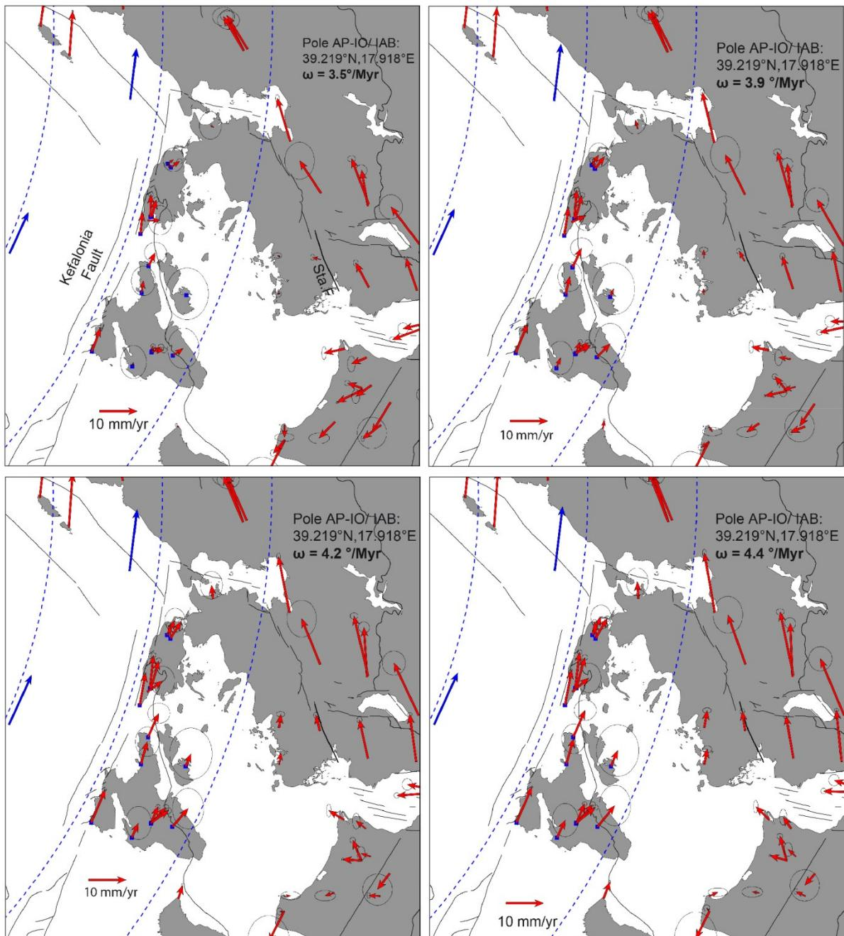
**Figure III.11 : Détermination de la vitesse angulaire du pôle AP-IO / IAB en fonction de l'azimut des résiduels.** Les valeurs de vitesses angulaires acceptables sont ici  $\omega = 3.9^\circ/\text{Myr}$  et  $\omega = 4.2^\circ/\text{Myr}$  car les résiduels sont parallèles de part et d'autre de la faille de Stamna.
