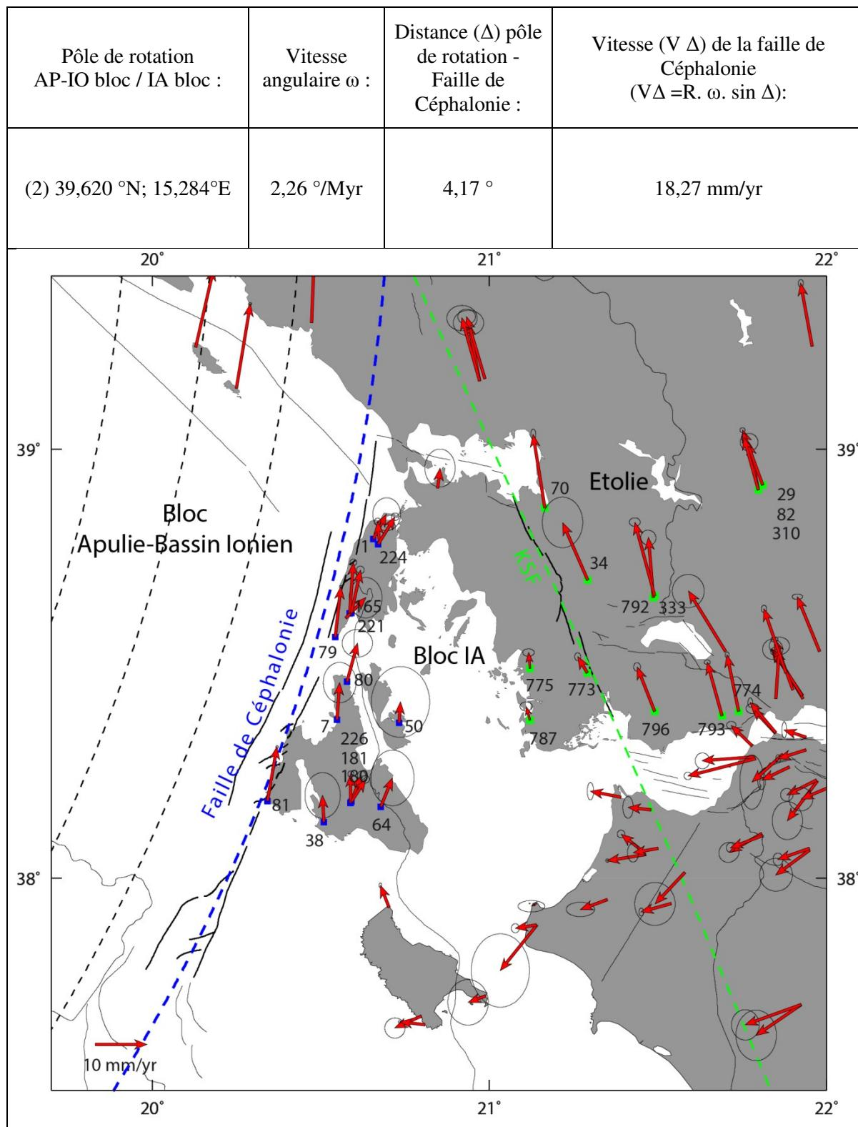
Figure III.14: Champ de vitesse obtenu pour les paramètres définis dans le tableau ci-dessus.
