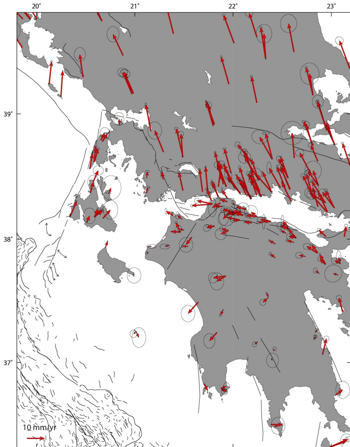
Figure III.24 : Champ de vitesses mesuré dans le référentiel LAB fixe, pôle 1,  $\omega = 4.2^\circ$  (Voir Figure III.13).
