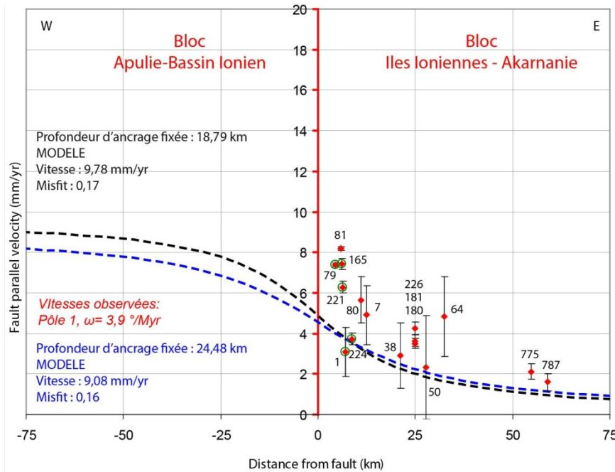
**Figure III.20 : Profil de vitesses GPS perpendiculaire à la faille de Céphalonie (composante parallèle à la faille), en considérant uniquement les sites de Lefkada Nord (sites 1 et 224).** Les courbes noires et bleues montrent ici des profils modélisés en fixant la profondeur d'ancrage (profondeur d'ancrages obtenus pour la faille de Céphalonie, voir Figure III.17).
