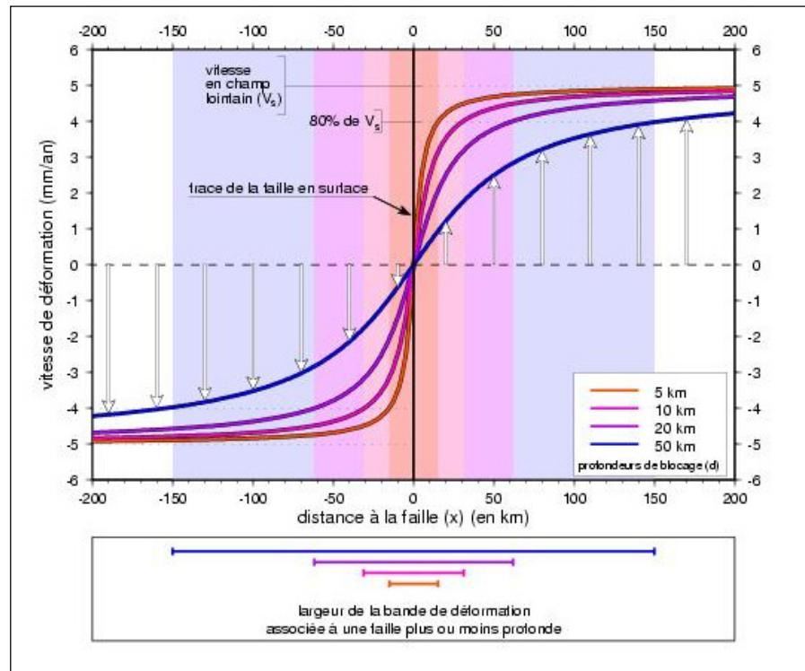
Figure III.7 : Exemples théoriques de champs de vitesse intersismique pour différentes profondeur de blocage.
