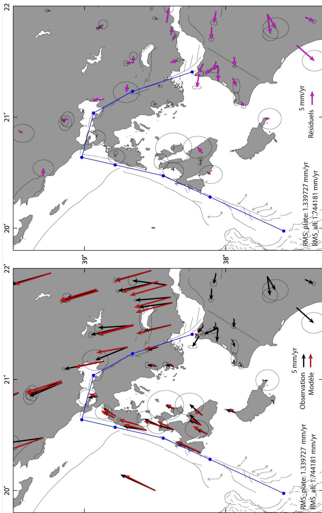
**Figure III.37 : Résultats du modèle de blocs.** Les paramètres sur les failles sont les mêmes que sur la Figure III.35. La seule différence est que nous avons utilisé le pôle lointain qui définit le mouvement rigide de la Grèce Continentale.
