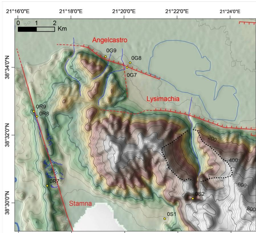
**Figure II. 12 : Zoom sur la zone d'Angelocastro-Lysimachia.** L'incision dans l'escarpement de Lysimachia forme un wine glass dans les flysch et une vallée encaissée dans les calcaires Ionien (OS2). L'escarpement de Lysimachia soulève des dépôts Pliocène à 500m d'altitude.
