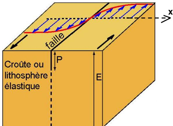
**Figure III.5 :** Bloc 3D illustrant le champs de vitesse intersismique théorique en surface  $V(x)$  associé à une dislocation élastique bloquée accommodant un mouvement décrochant en profondeur [Savage and Burford, 1973].  $V(x)$  est défini par :
