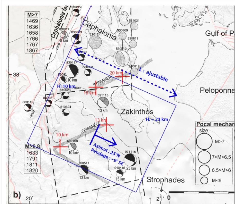
**Figure III.31 : Figure de [Laigle et al., 2002] qui reporte le tracé des campagnes STREAMERS et SEISGREECE. Les croix rouges indiquent les profondeurs du plan plat imaginé par [Hirn et al., 1996] et [Clement et al., 2000]. En bleu sont reportés les paramètres que nous définissons pour la géométrie du plan. H: profondeur du plan, L: projection de la longueur du plan.**
