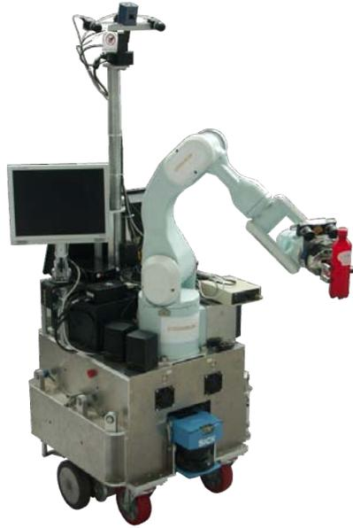
FIGURE 2.7 – Plate-forme mobile avec un bras 6 DOF : JIDO
