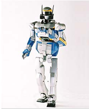
FIGURE 2.1 – Humanoid Robotics Project (Hrp2), développé par Kawada Industries.
