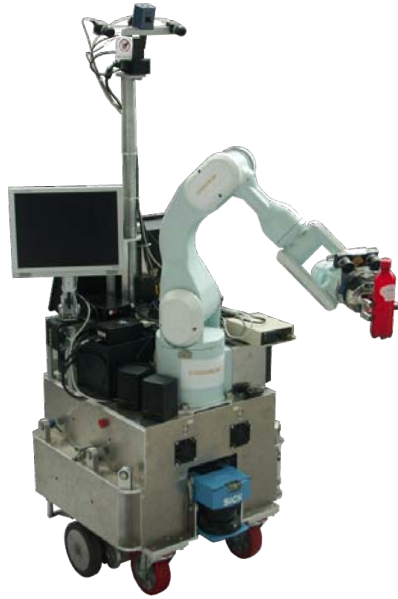
FIGURE 2.7 – Plate-forme mobile avec un bras 6 DOF : JIDO
