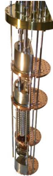
FIGURE 3.4: Photographie d'un cryostat à dilution vertical typique. On voit bien le grand bras de balancier au bout duquel est placée la zone froide.
