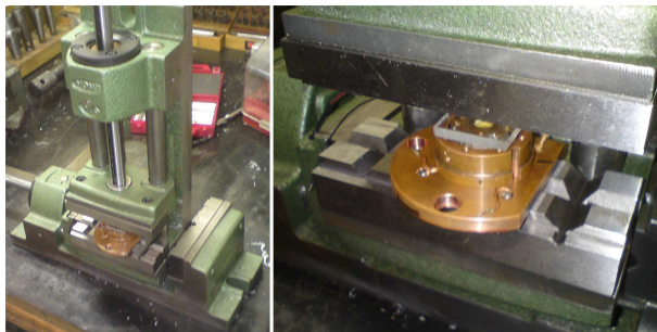
FIGURE 4.37: Photographies de la procédure d'emmanchement de la cale piézo-électrique.
