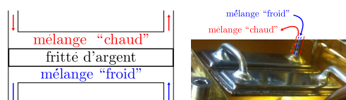
FIGURE 3.13: Schéma et photographie d'un échangeur à fritté d'argent. Les fluides froids circulent à l'intérieur et les fluides chauds à l'extérieur dans les tubes d'alimentation.
