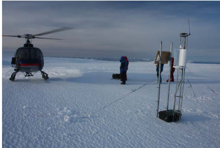
FIGURE 4.7 – Photographie d'une balise GPS implantée sur la partie posée du glacier de l'Astrolabe. On distingue l'antenne GPS fixée en haut du mât en métal, l'éolienne blanche sur le devant. Le panneau solaire est fixé sur deux poteaux, à gauche du mât. La valise noire placée au pied du mât contient la batterie et le récepteur GPS ( Photo : E. LeMeur )
