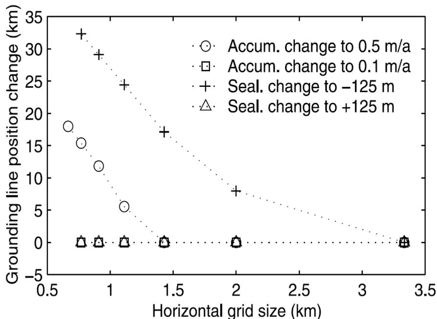
FIGURE 3.2 – Exemple de dépendance des résultats des modèles de calotte à la taille de grille : résultats du modèle de *Ritz et al.* (2001), où la variation totale de la position de la ligne d'échouage au cours d'une simulation de relaxation (après les perturbations indiquées par les symboles) est représentée en fonction de la taille de grille (*Vieli and Payne*, 2005).
