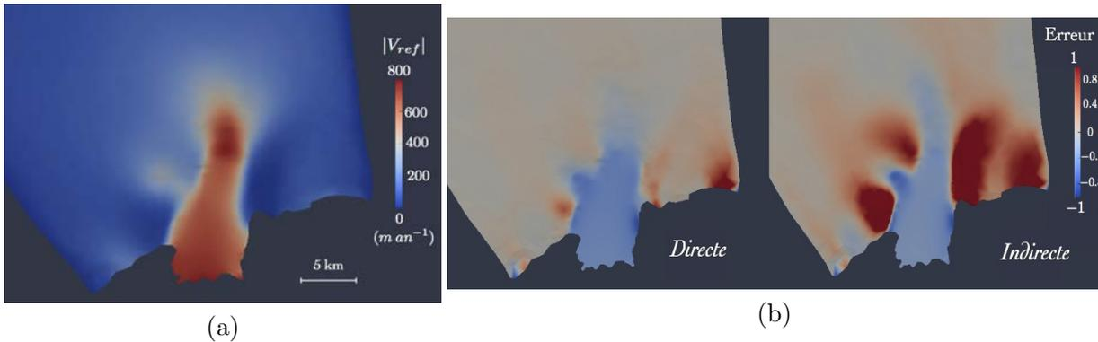
FIGURE 4.18 – Comparaison des perturbations de socle obtenus par méthode *directe* et *indirecte* par rapport à l'état de référence : (a) norme de la vitesse horizontale de l'état de référence relaxé et (b) différence relative de la vitesse de Neumann (vitesse modélisée) par rapport à la vitesse de Dirichlet (vitesse de référence)  $\frac{V_N - V_D}{V_D}$  pour chacune des méthodes *directe* et *indirecte*.
