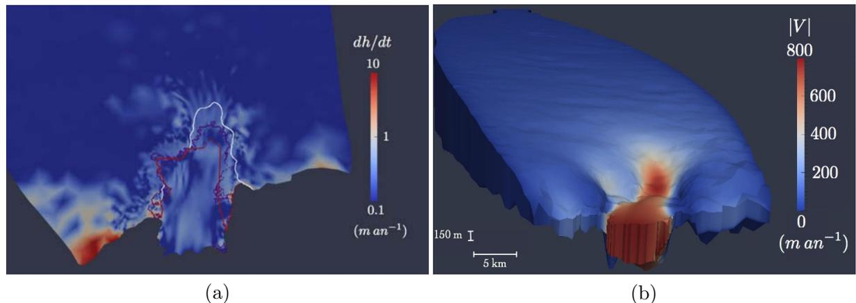
FIGURE 4.15 – Résultats de la fin de la relaxation : (a) représentation des vitesses verticales de surface,  $dh/dt$  et de la ligne d’échouage finale (violette), en comparaison à la ligne d’échouage initiale (rouge) et à celle déduite de *Bindenschadler et al.* (2011) (blanc). (b) représentation du maillage “quasi-stationnaire” et de la norme des vitesses modélisées associées.
