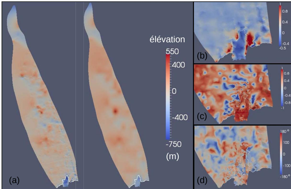
FIGURE 4.11 – (a) Elévation du socle sur les noeuds du maillage 2D, interpolé à partir de la méthode directe (gauche) et de la méthode indirecte (droite). Différence relative entre les deux méthodes de l'épaisseur de glace (b), de l'amplitude de la pente (c). (d) Différence d'azimut de la pente.
