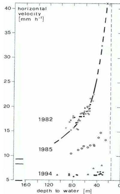
FIGURE 1.7 – Mesures des vitesses d'écoulement de surface en fonction de la pression d'eau effective (*Iken and Truffer, 1997*)
