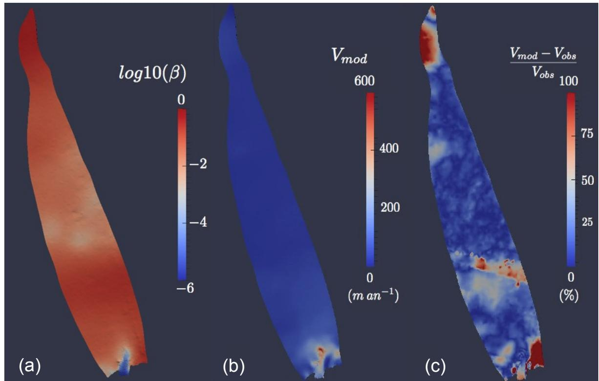
FIGURE 4.14 – Représentation des résultats à la fin de l’optimisation avec  $\lambda = 10^7$  : (a) paramètre  $\alpha$  déduit de la minimisation de la dérivée de la fonction coût. (b) vitesses de surface modélisées (vitesses de Neumann). (c) erreur relative des vitesses de surface,  $\frac{|u_{obs} - u_{mod}|}{u_{obs}}$  en %.
