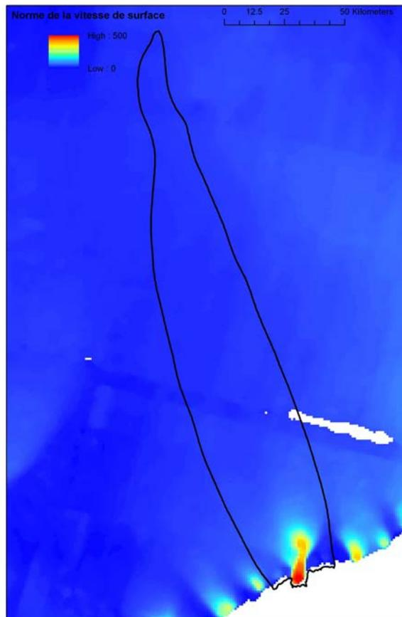
FIGURE 4.9 – Vitesses de surface mesurées par interférométrie radar dans la région de l'Astrolabe (*Rignot et al., 2011a*).
