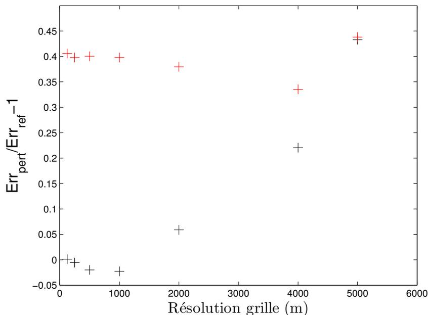
FIGURE 4.19 – Représentation de l’erreur moyenne de vitesse  $|\delta V|$  normalisée sur l’erreur moyenne des vitesse pour l’inversion de *référence*, en fonction de la résolution de la grille du jeu de donnée original, pour les expériences dont le socle est déduit à partir de la méthode *directe* (noir) et *indirecte* (rouge).
