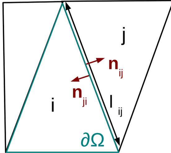
FIGURE 2.4 – Schéma du principe de la conservativité des flux.
