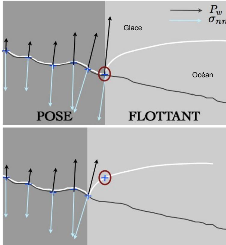
FIGURE 2.2 – Illustration du problème de contact : pour tous les noeuds posés (croix bleues), la différence entre la contrainte normale à la surface inférieure de glace  $\sigma_{nn}$  et la pression exercée par l'eau  $P_w$  est testée. Lorsque cette dernière est supérieure, la condition aux limites appliquée à ce noeud est une condition aux limites de Neumann (cercle rouge) (équation 2.9), le noeud devient flottant et la ligne d'échouage recule.
