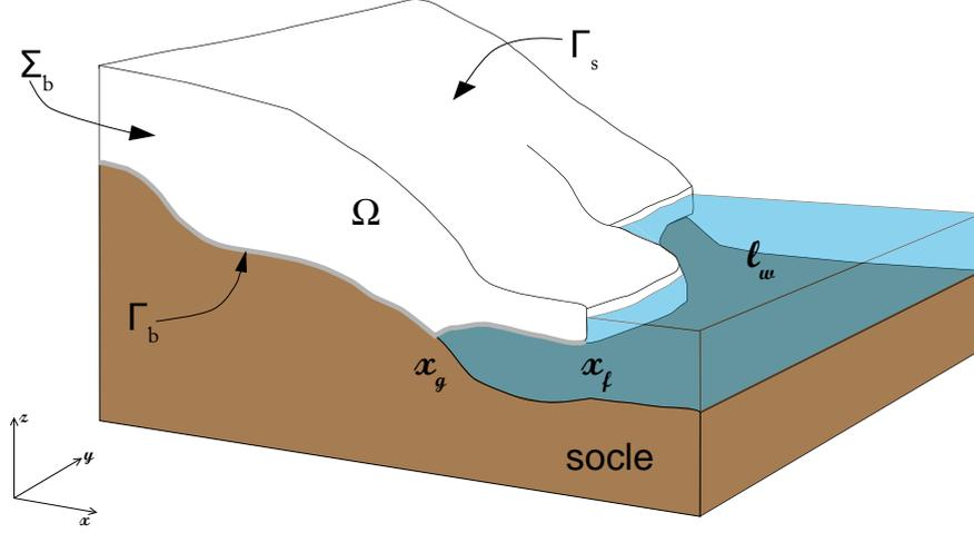
FIGURE 2.1 – Représentation du domaine modélisé  $\Omega$ , défini par la surface supérieure  $\Gamma_s$ , la surface inférieure  $\Gamma_b$  (ligne grise), les bords latéraux  $\Sigma_b$ , et le front de vêlage délimité par  $x_f$ .  $x_g$  correspond à la position de la ligne d'échouage et  $\ell_w$  au niveau de la mer.
