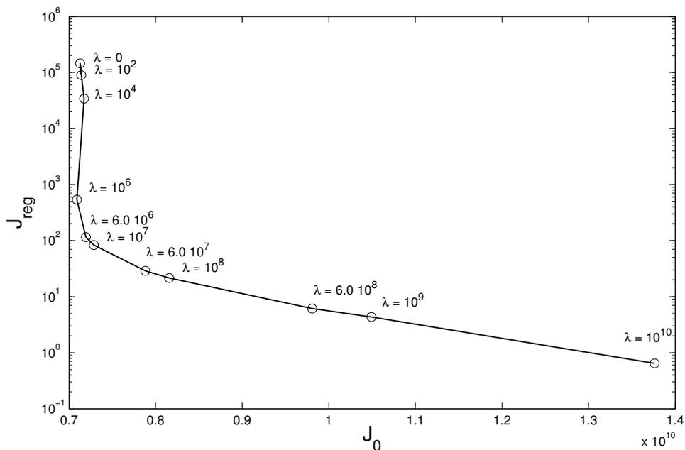
FIGURE 4.13 – Représentation de  $J_{reg}$  en fonction de  $J_0$  de différentes inversions, chacune étant caractérisée par un paramètre  $\lambda$ . Le paramètre de régularisation  $\lambda$  optimal est  $\lambda = 10^7$ .
