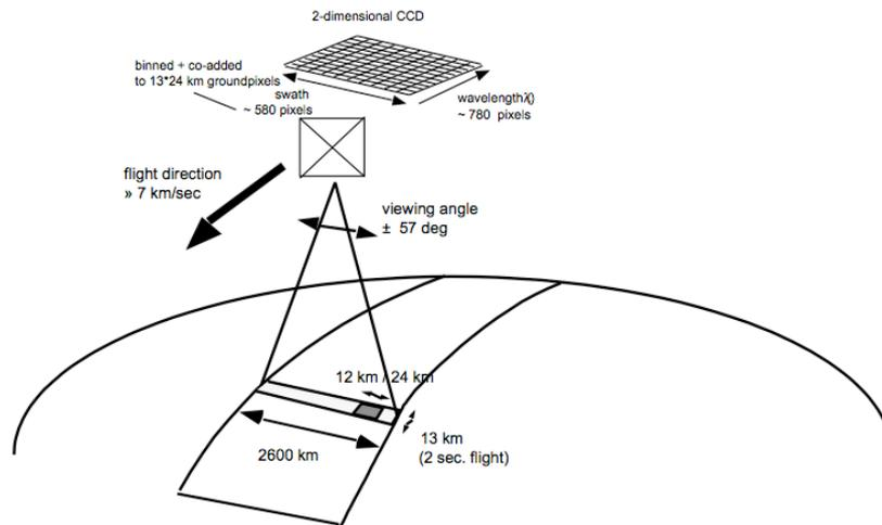
**Figure C.1** Principe de mesure d'OMI (Levelt et Noordhoek, 2002).
