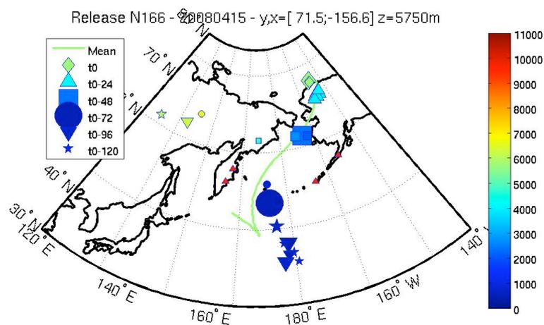
**Figure B.2** Rétrotrajectoires à partir des simulations FLEXPART initialisées le 15 avril 2008 à 01:16:00 UTC à  $71.5^\circ\text{N}$ ;  $156.6^\circ\text{W}$  entre 5500-6000 m. Les clusters de particules sont représentés toutes les 24 h à partir du début de la simulation. La colorbar représente l'altitude des clusters en mètres.
