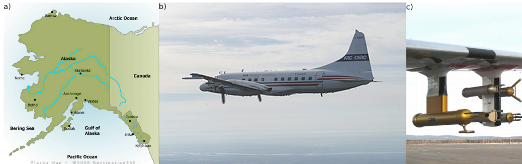
Figure 1.7 (a) Carte de l'Alaska (b) Avion «Convair-580» du NRC utilisé pendant ISDAC (c) Quelques capteurs microphysiques du Convair-580 (sens horaire à partir du haut à gauche): 2DC, 2DP, 2DS, Fast-FSSP et CSI/CDP ( http://acrf-campaign.arm.gov/isdac/ ).
