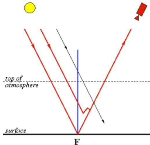
**Figure C.2** Représentation schématique de la voie oblique (lignes rouges) de la lumière solaire à travers l'atmosphère de la Terre vers le satellite, associée à l'empreinte E (Surface de la terre pointée par le satellite). La ligne bleue représente la «colonne verticale» au-dessus de l'empreinte E
