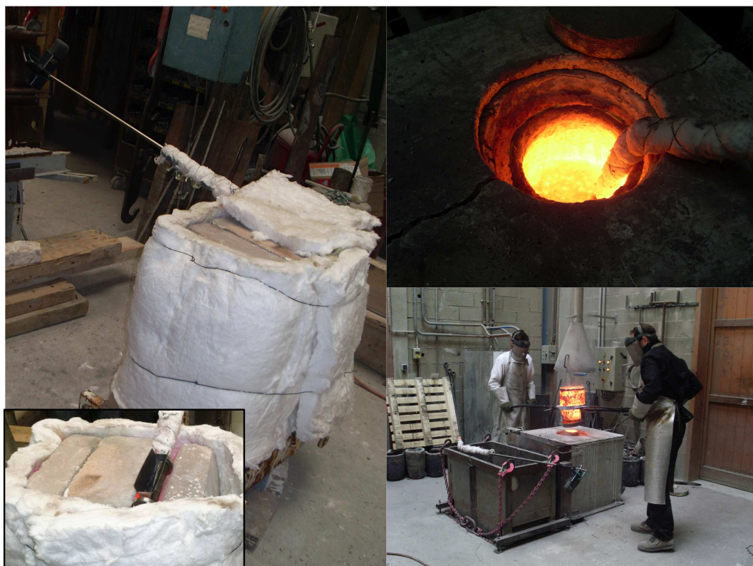
FIGURE 5.2 – Site de la coulée à la Fonderie de Coubertin. A gauche, isolation du moule demi-coque pendant son chauffage avec le moule ligotage posé au dessus. A droite, préparation de l'alliage de cuivre en fusion pour coulage.
