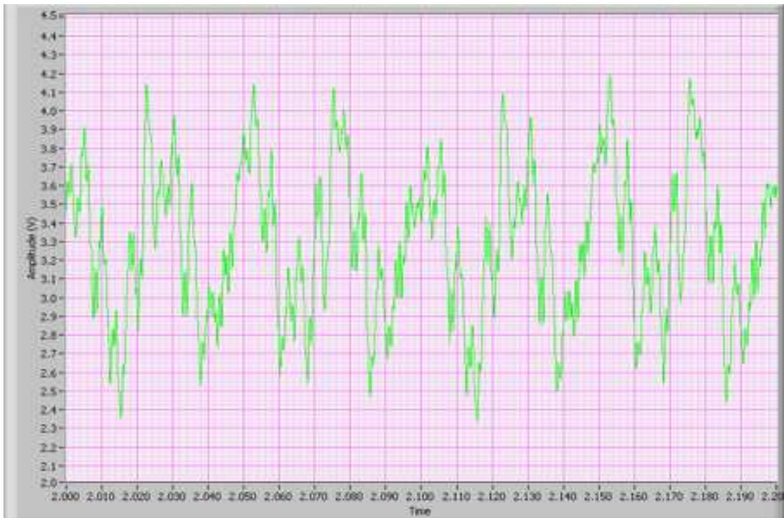
FIGURE B.1 – Signal de sortie en tension en fonction du temps du conditionneur LVDT avec alimentation à découpage.
