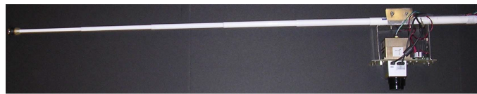
FIGURE 1.3: Exemple d'un prototype de canne instrumentée pour des aveugles basée sur les MEMS [Hesch et Roumeliotis, 2007]
