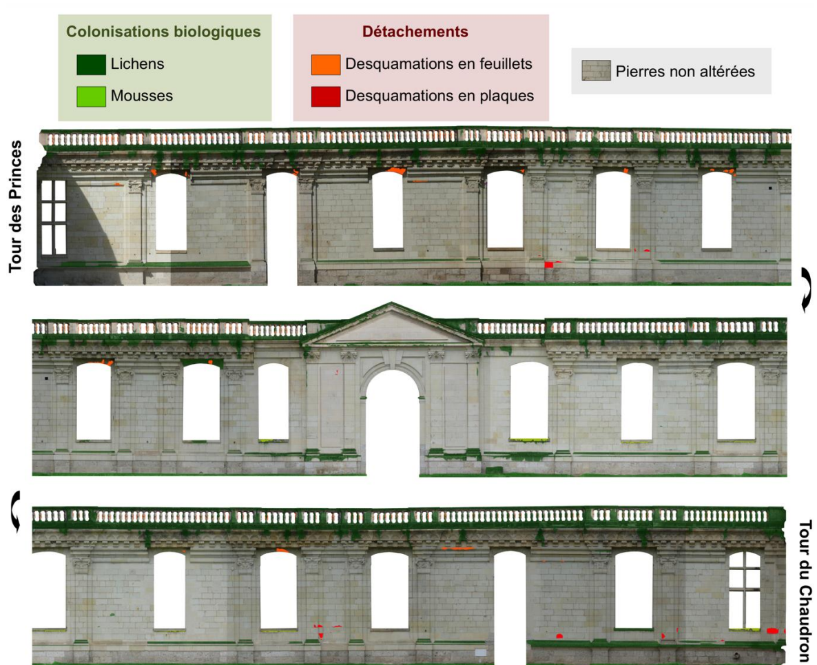
FIGURE 56 : CARTOGRAPHIE DE REPARTITION DES ALTERATIONS SUR L'AILE SUD
