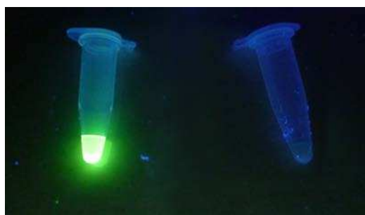
Figure 4.4 – Photo de tubes eppendorf ® contenant une solution à 50 \text{ mM} de complexe [\text{Tb}(\text{HMTDPA})_3]^{3-} , à gauche, et d'une solution de ligand HMTDPA, à droite, sous exposition aux UV ( \lambda = 315 \text{ nm} ) et en salle noire.
