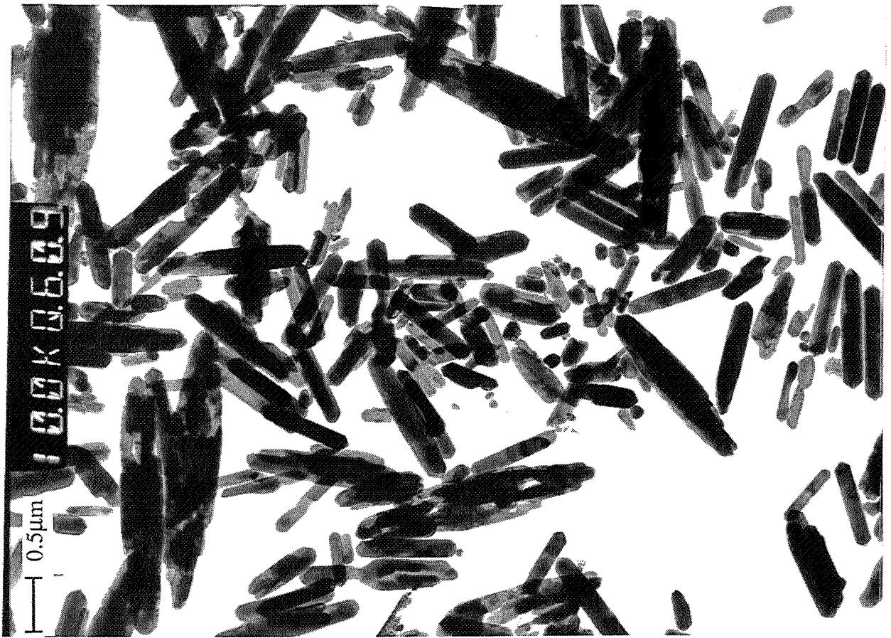
Cliché I.20 : Cliché M.E.T. du solide HCa ( ——— 0,5μm)
