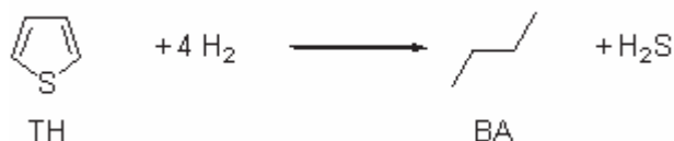
Figure 1-16. Réaction du thiophène avec H 2 .
