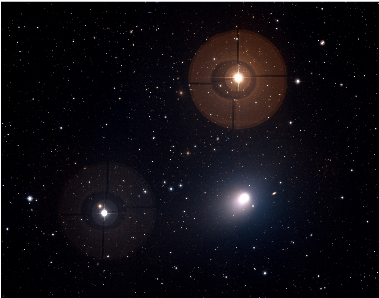
Fig. 5.3.: Exemple d'image, enregistrée par MegaCam. En regardant les taches produites par les étoiles, il est possible de distinguer la couronne circulaire, qui reproduit la forme du miroir primaire et de l'araignée de soutien. Le halo est causé par la fraction de lumière provenant de l'étoile réfléchi par l'optique de l'imageur.
