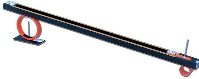
Figure 38. Maillemètre utilisé pour mesurer la longueur des fibres d'Alfa
