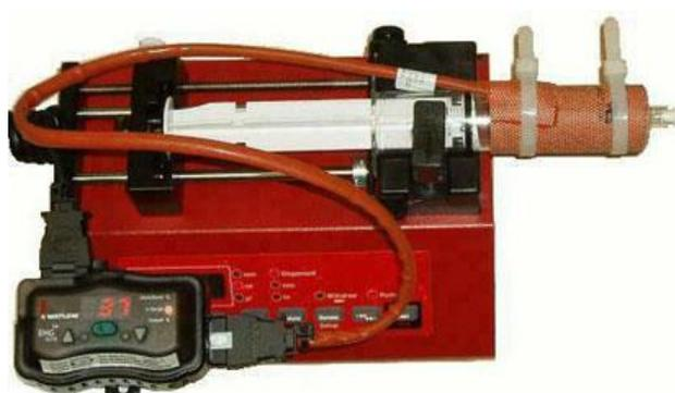
Figure 85. Pousse seringue NE-1010 avec le système de chauffe
