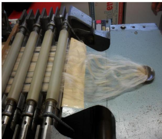
Figure 71. 3 passages supplémentaires au banc d'étirage : 8 rubans à l'entrée
