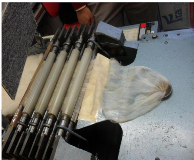
Figure 70. Premier passage au banc d'étirage : formation du ruban à partir d'une nappe de fibres
