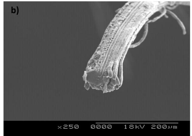
Figure 48. Images MEB d'une surface de fibre  $\alpha 2$  (a) et une vue de la section (b)
