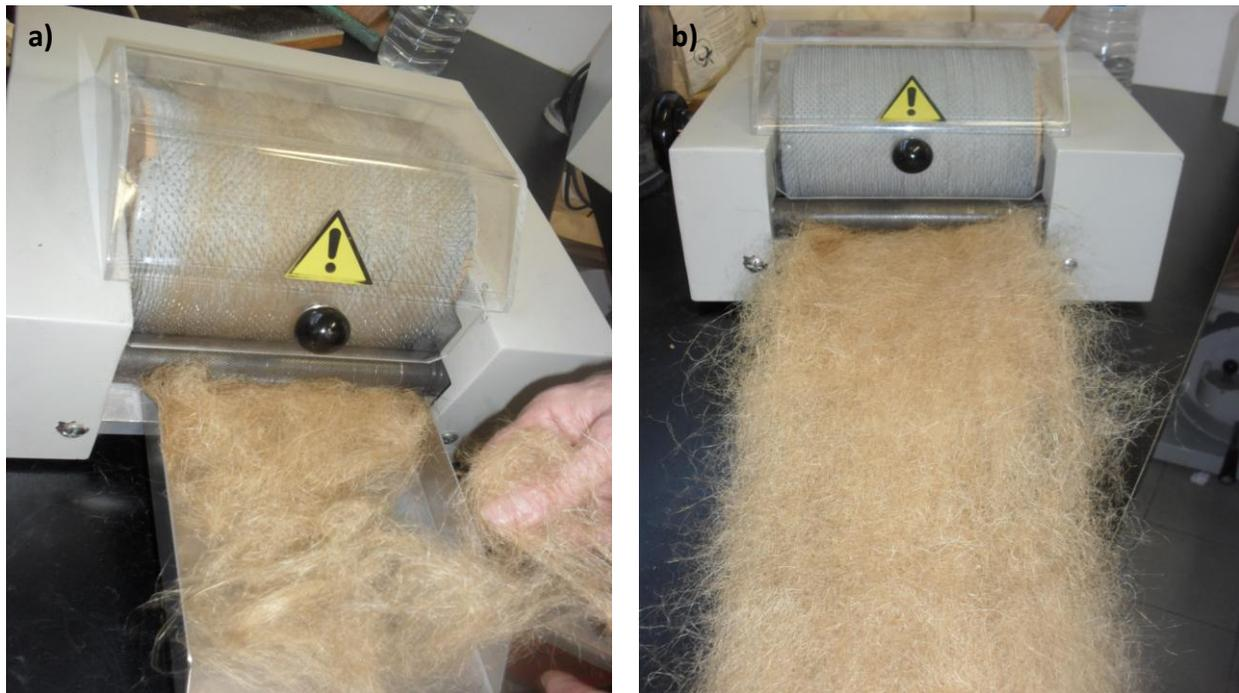
Figure 69. (a) Des fibres d'Alfa en bourre à l'entrée de l'ouvreuse
