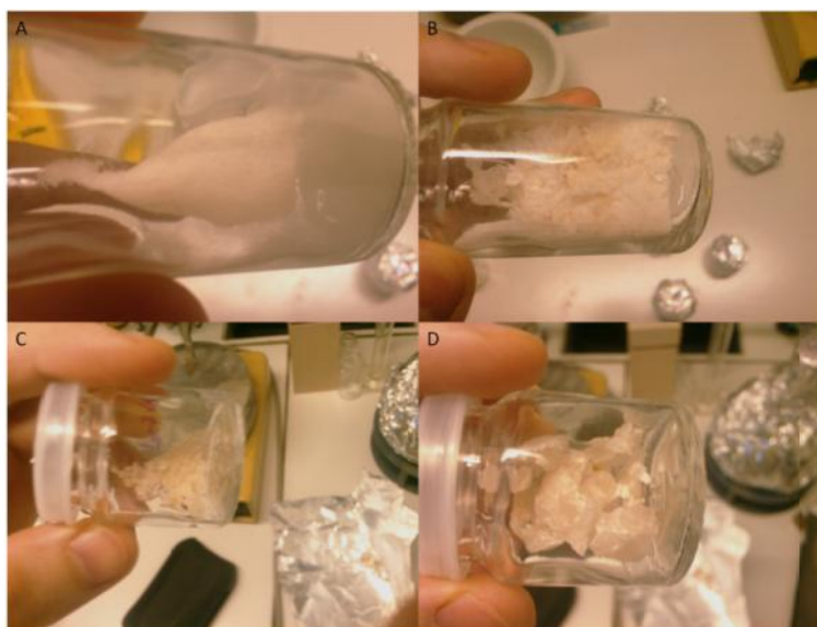
Figure 38 : Comparaison des produits obtenus selon le mode de purification: Solution de PVAm diluée à 3% et précipitation dans l'acétone (A), Solution de PVAm 20% et précipitation dans le toluène puis ajout d'acétone (B), Solution de PVAm 20% et précipitation dans l'acétone (C) et dialyse du PVAm (D)
