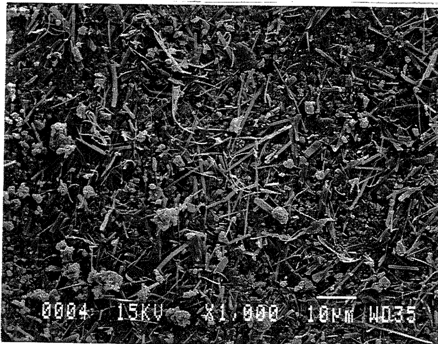
Fig.III-10b : Observation au M.E.B. de la surface d'une seconde pastille d'alumine- \beta non traitée et gardée en air ambiant pendant 2 mois.
