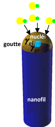
FIGURE 3.30 - Illustration schématique de la croissance VLS-HVPE, régie essentiellement par l'apport de la matière première directement de la phase vapeur dans la goutte. \gamma_{gl} est l'énergie par unité de surface des interfaces latérales entre le germe et le liquide, \gamma_{gs} entre le germe et le substrat.
