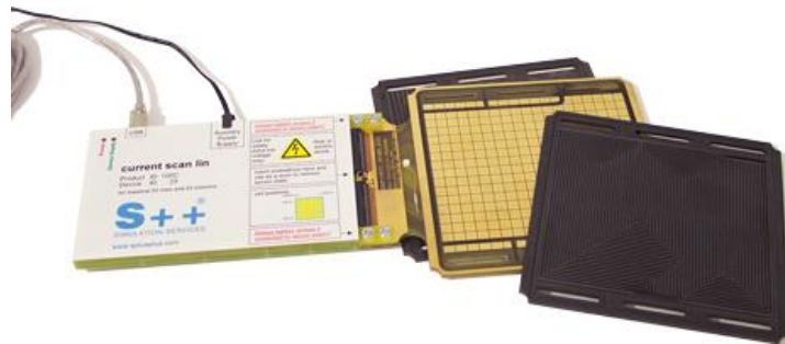
Fig. 13 : Plaque de mesure invasive de densité de courant [S++].
