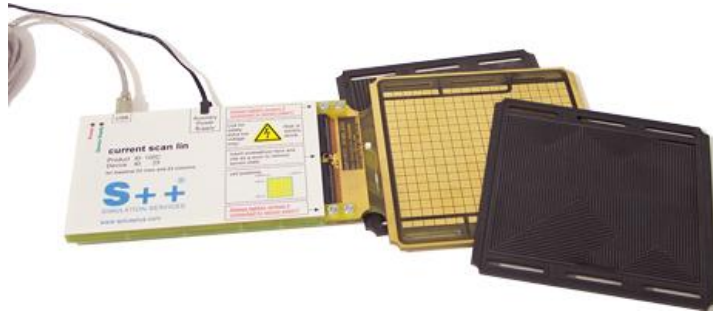
Fig. 103 : Plaque invasive de mesure de densité de courant [S++].
