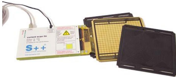
*Fig. 103 : Plaque invasive de mesure de densité de courant [S++].*
