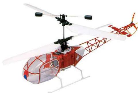
FIG. 1.9 – L'hélicoptère à hélices coaxiales XRB Lama de Hirobo.
