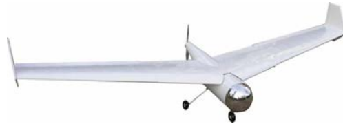
FIG. 1.15 – Le petit avion Lhassa du LAAS. (3 mètres d'envergure, 6 kg)
