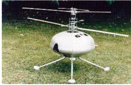
FIG. 1.10 – L'hélicoptère à hélices coaxiales de l'université de Bangor.
