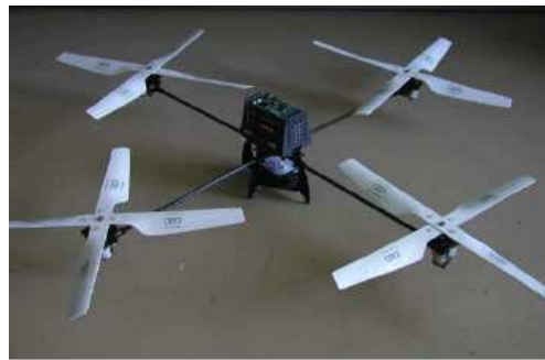
FIG. 1.11 – Le quadrirotor du projet ROBVOLINT. (Envergure : 50 cm).
