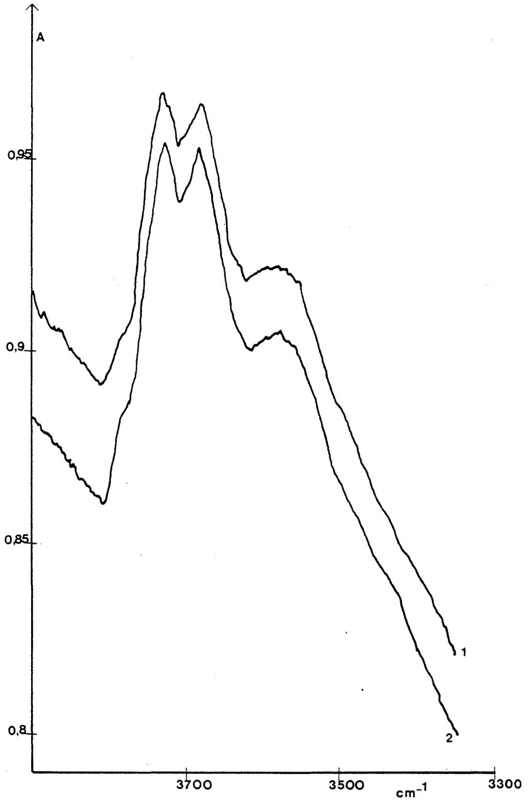
figure 13 : Spectres infrarouges, à 573 K, dans la zone caractéristique des groupements ( OH ) , des échantillons SCM 129X (1) et Référence (2)
