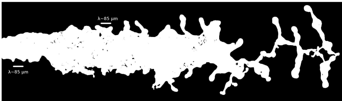
FIGURE 5.48: Photographie expérimentale binarisée de l'écoulement externe
