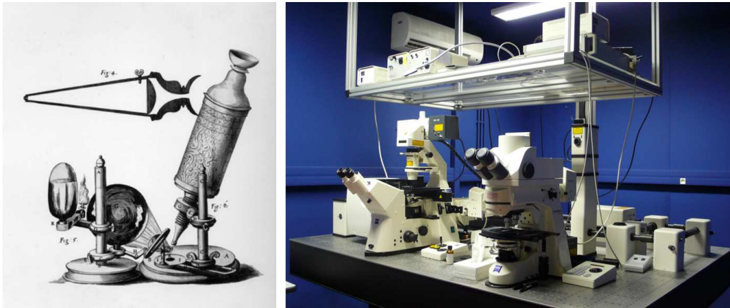
FIGURE 2.5.: A gauche : microscope de Robert Hookes. Le mécanisme est resté sensiblement le même dans les microscopes classiques : le tissu est rétro-éclairé, puis les rayons lumineux qui traversent le tissu sont collectés par un système de lentilles pour former l'image. A droite, le microscope laser à émission multi-photonique du PHIV est un microscope très sophistiqué et ses différents éléments (laser, système de refroidissement, tubes de confinement du rayon laser, jumelles d'observation et interface informatique) occupent une pièce entière.
