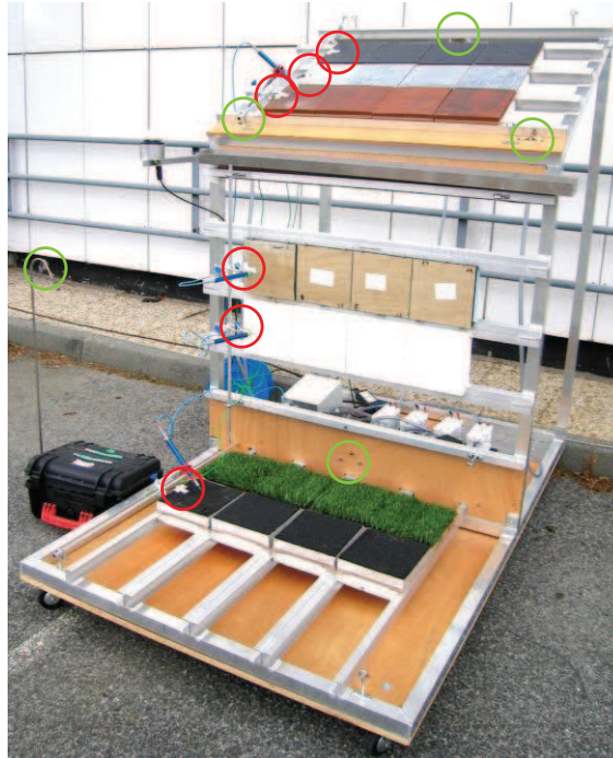
Figure III-8 : bâti-support équipé des éprouvettes urbaines (verre et enduit de façade verticaux, bitume et herbe horizontaux, ardoise, tuile et zinc obliques à 30°) et valise mobile de prélèvement sur filtre (à gauche). Une éprouvette de chaque surface (sauf l'herbe) est équipée d'un thermocouple (en blanc dans les cercles rouges). Les points de prélèvements d'aérosols sur filtres sont encerclés en vert.
