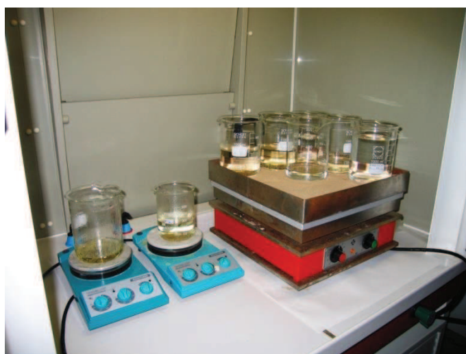
Figure annexe 5 : bain de sable chauffant, plaques chauffantes et béchers (contenant des solutions de rinçage des éprouvettes) utilisés pour la réduction des volumes de solution.
