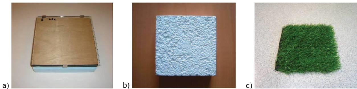
Figure II-9 : éprouvettes carrées de 200 mm de côté, de verre posé sur un support polystyrène-bois (a), d'enduit de façade (b) et d'herbe synthétique (c).
