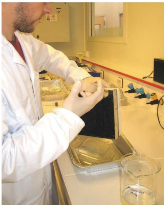
Figure annexe 3 : rinçage à la seringue d'une éprouvette de bitume.
