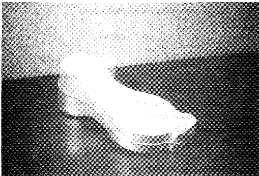
Photo 1 : matricé épais 7091, produit non dégazé ; la pièce est fendue au cours du traitement thermique.
