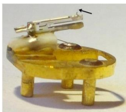
Figure 28 - Sonde à diapason piézoélectrique (CITIZEN AMERICA CFV206 40.000KAZF) dotée d'une pointe platine/iridium de 50 microns de diamètre et effilée électrochimiquement (indiquée par la flèche noire) permettant les mesures STM et AFM simultanées. Cette sonde a été entièrement réalisée par nos soins.
