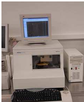
Figure 2 - 20: Photographie d'un profilomètre mécanique à gauche (KLA Tencor P16)
