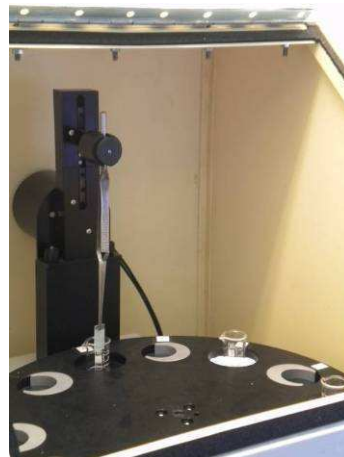
Figure 2 - 6 : Principe du dépôt par dip coating et l'appareil effectivement utilisé au laboratoire
