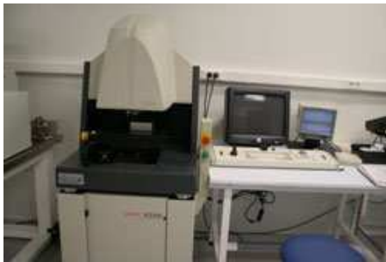
Figure 2 - 21 : Photographie d'un profilomètre optique Veeco et son principe de fonctionnement
