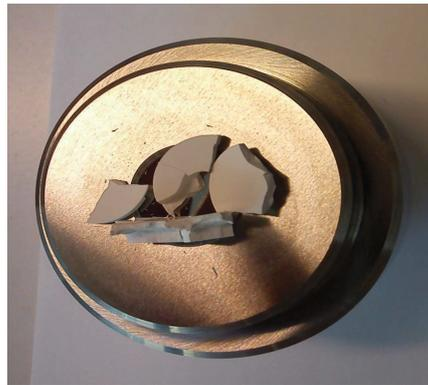
**Figure A5-12** : Photo d'une pastille de Sicade<sup>®</sup> réalisée sans solution de consolidation et pressée à 3 tonnes à la sortie de la pastilleuse.
