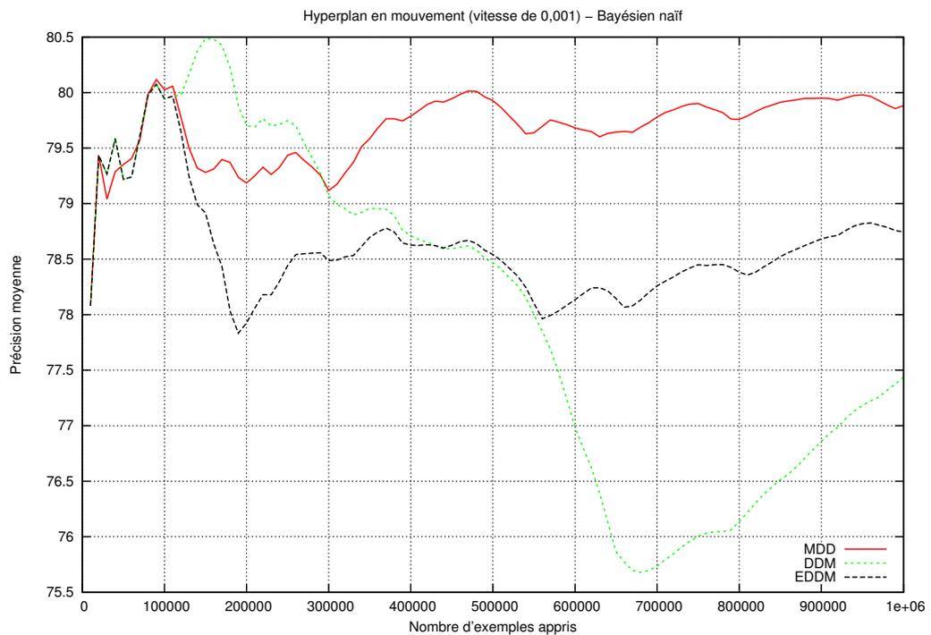
FIGURE 5.10 – Précision moyenne sur les différentes méthodes de détection (classifieur bayésien naïf avec le jeu de données Hyperplan en mouvement).
