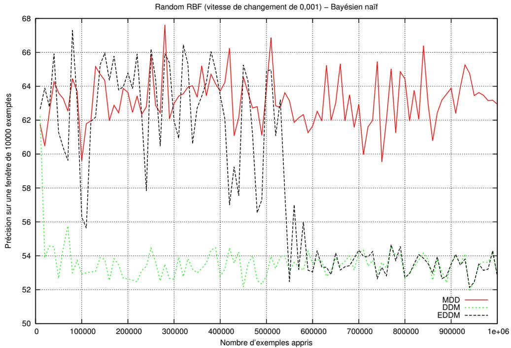
FIGURE 5.11 – Précision sur une fenêtre de taille 10000 sur les différentes méthodes de détection (classifieur bayésien naïf avec le jeu de données Random RBF en mouvement).
