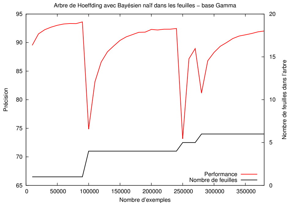
FIGURE 4.4 – Mise en évidence de l’inadéquation des arbres de Hoeffding avec les bases du challenge Large Scale Learning (base Gamma).
