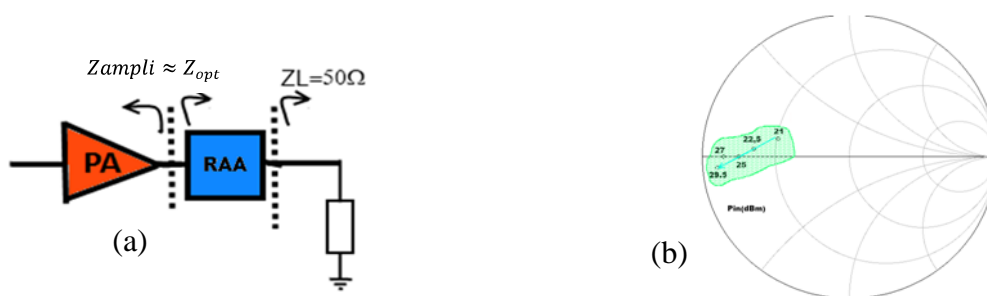
Figure III-50: (a) Schéma du démonstrateur, PA+RAA+charge (b) Région de Z_{opt} à couvrir.
