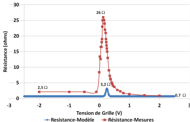
Figure III-80 : Caractéristique R(V) des mesures et simulation du modèle varactor MOS SOI
