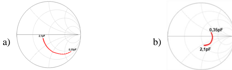
Figure II-55: Plage d'impédances en fonction de la capacité en entrée a) A l'entrée du PA et b) à la sortie du PA
