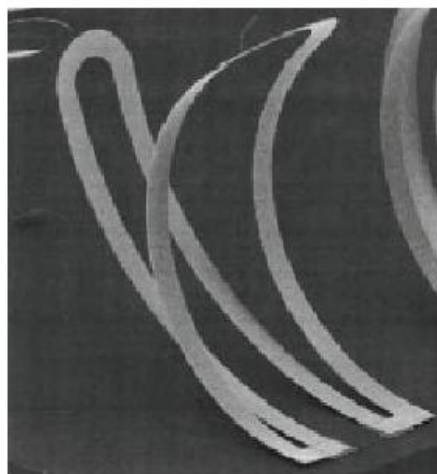
Figure I-53: Photographie d'une inductance MEMS variable [Lub01].
