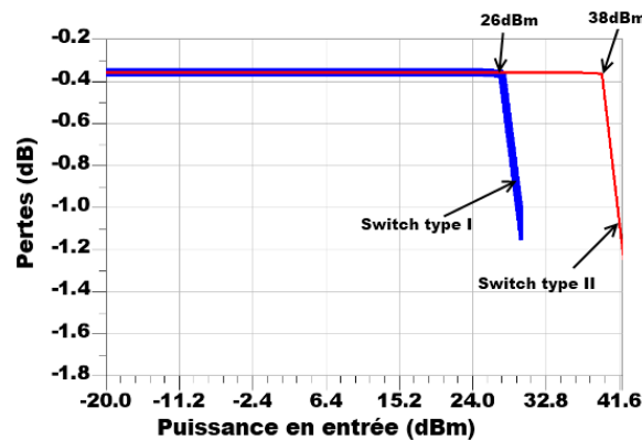
Figure III-62: Pertes d'insertion du RAA en fonction de la puissance appliquée et estimation du point de compression du RAA, avec les « switches » de type I et II.
