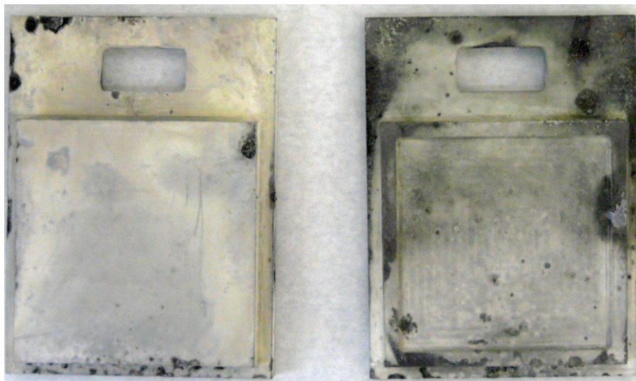
Figure 5.21 : Photographie de l'état de surface des pièces de graphite siliciurées par IRG avant le dépôt du revêtement \text{Si}_3\text{N}_4 ; la largeur totale des pièces fait 80 mm et le trou dans la partie supérieure des pièces permet le maintien en position lors de la siliciuration
