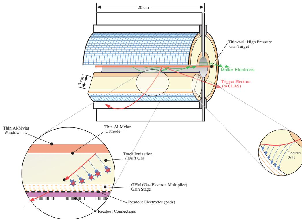
FIGURE 3.9 – Principe de fonctionnement de la RTPC.
