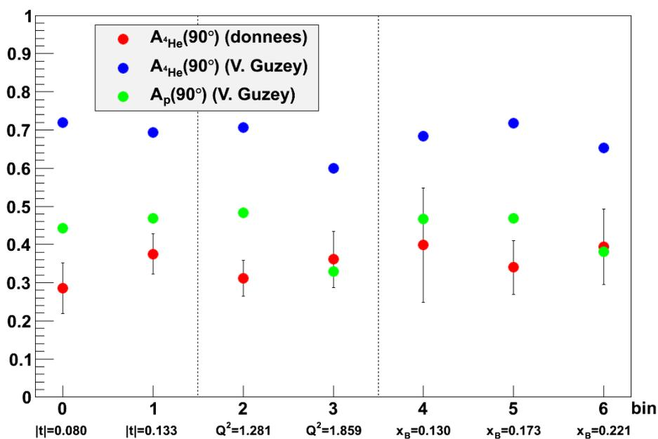
FIGURE 5.23 – Comparaison de l'amplitude de l'asymétrie à  $90^\circ$  obtenue à partir de l'ajustement des données par rapport au modèle de V. Guzey. Les points rouges correspondent aux données, les points bleus à l'amplitude de l'asymétrie sur l'hélium 4 et les points verts à l'amplitude de l'asymétrie sur le proton.
