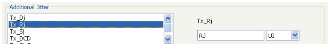
FIGURE 2.13.: Déclaration de jitter additionnel dans les modèles IBIS AMI (ADS 2012)
