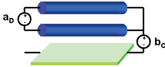
FIGURE 5.6.: Conversion du mode différentiel vers le mode commun
