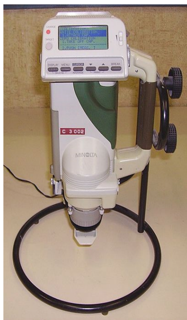
Figure II.11. Spectrocolorimètre pour mesure de la couleur dans le système L^*a^*b^*
