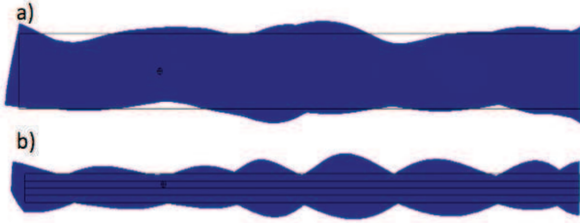
Figure 25 : Déformée du modèle de plaque stratifiée [-45/-45/45/45] avec un défaut : face supérieure (a), face latérale (b)
