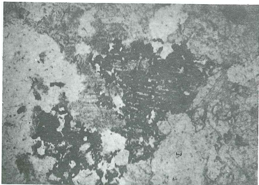
Fig. 23 - Lamelles de micas (phengite et muscovite) aux clivages soulignés par des trainées d'oligiste (LN x 100).
