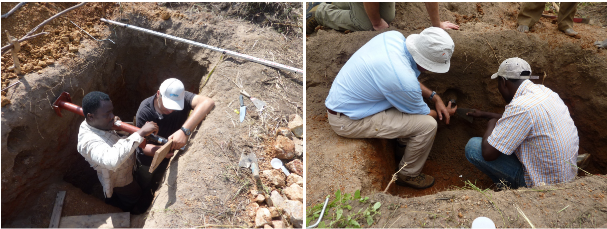
FIGURE 5.4 – Prélèvement de cylindres de densité sur le bassin versant de l'Ara, novembre 2010
