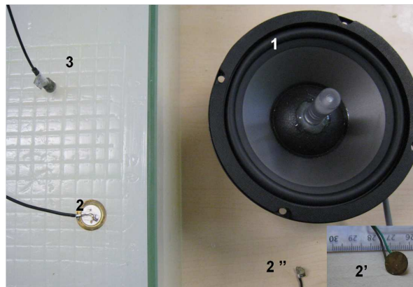
FIGURE 2: (1) haut parleur (2), (2') (2'') sources piézo-électriques (3) accéléromètre
